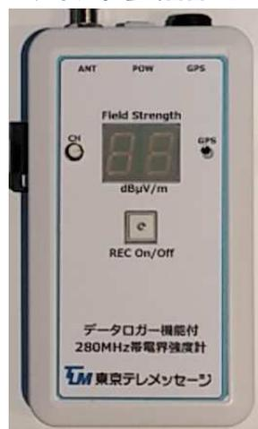
240MHz~960MHzの範囲のいずれか1波で簡単に電波強度(dBμV/m単位での電界強度)を測定できる乾電池駆動のハンディ計測器です。RFA-Proは、RFS-Proにそのまま読み込める形式の実測データファイルをSDカードに記録できます。(付属のGPS受信機で得られた緯度・経度・時刻とともに1秒ごとの実測値を記録します。なお、RFA-Liteに記録機能はありません。)
